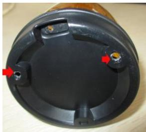
④ Connecter les câbles d'alimentation. Fixer ensuite le socle de la lampe sur le support avec 3 vis taraudées de Ø3x12mm.
