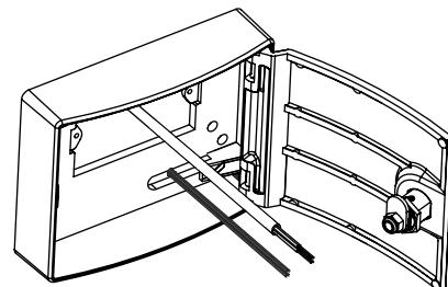
**FR-** Passer le câble d'alimentation et le câble de débrayage à travers les trous prévus à cet effet
