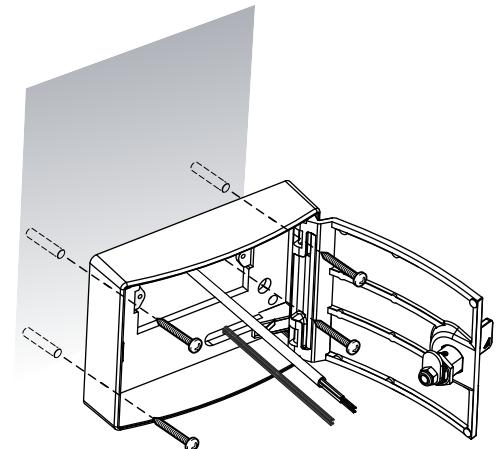
**FR-** Fixer le boîtier de débrayage au mur avec les éléments de fixation appropriés
